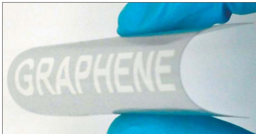
Рис.4. Прозрачное, прочное, гибкое, электропроводящее покрытие («несколько-кослойный» графен), нанесенное с помощью пульверизатора на пластик для оптоэлектронных применений (сенсорные экраны, жидкокристаллические экраны и др.). Манчестер, 2008.
